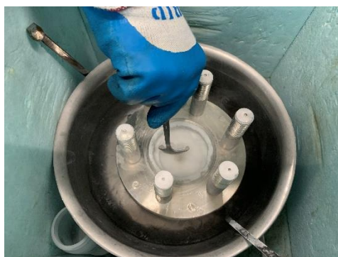
解析用サンプルハイドレート採取の様子
